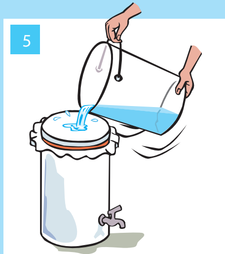
Đổ nước đã được xử lý vào bình đựng qua 1 miếng vải lọc
